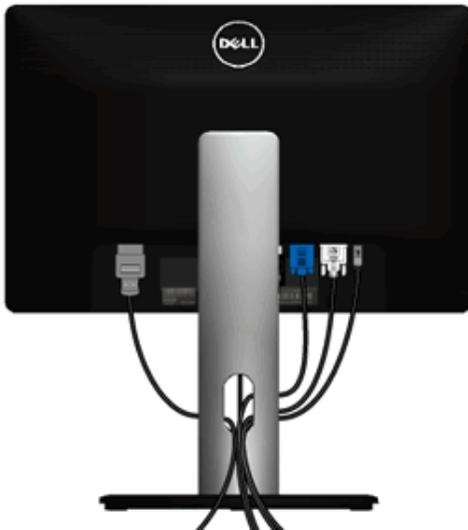
Nachdem Sie sämtliche erforderlichen Kabelverbindungen an Monitor und Computer hergestellt haben (siehe [Monitor anschließen](#)), führen Sie die Kabel wie oben gezeigt ordentlich durch den Kabelschacht.
